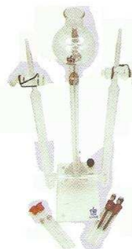
Aparato de Hoffman para electrólisis con llaves especiales y electrodo
