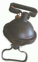
Hemisferio de Magdeburgo para demostración de presión atmosférica
