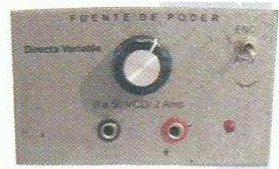
Fuente de Tensión de 0 a 50 VCD 5 AMP Regulada
