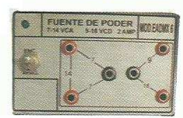
Fuente de Tensión 7-14 VCA y 9-18 VCD 2AMP
